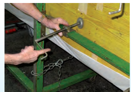
... und abschließendes Verpressen (ca. 3-6 Std bei +20 °C)
