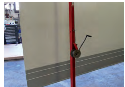
6. Blech aufhängung für die spätere exakte Positionierung
