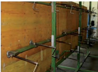
4. Detailansicht: Anpressvorrichtung vorbereiten
